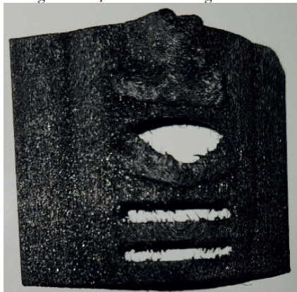
► Figura 6. Peça final das cartilagens em TPU.
